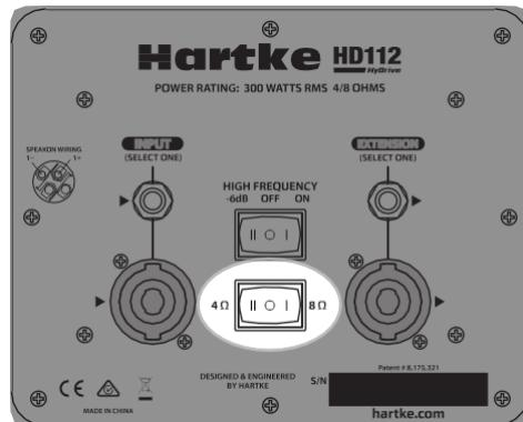
**NOTA:** Prima di impostare il selettore di impedenza per evitare danni all'amplificatore, assicurati di controllare l'impedenza di sicurezza minima consigliata dal produttore per il tuo amplificatore.
